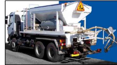
*L'enrobé projeté à l'aide d'une machine « Blow-patcher » ou similaire + compactage au petit cylindre*
